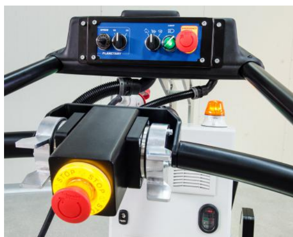
Comandi per movimentazione per versione Self Track.
