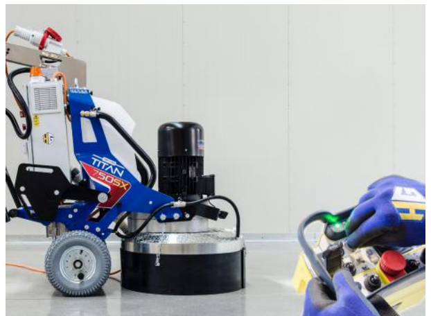
Avanzamento e brandeggio automatico (versione SX).
