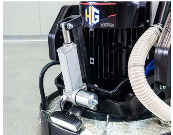
Attuatore lineare con regolazione elettrica della pressione di lavoro.
