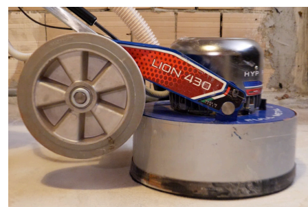
MODALITÀ CARTEGGIATRICE: Testa rigida e ruote sollevate.
