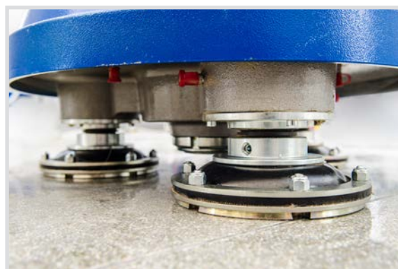
I satelliti porta utensili con nuovi giunti flessibili anti-shock aumentano stabilità e maneggevolezza.
