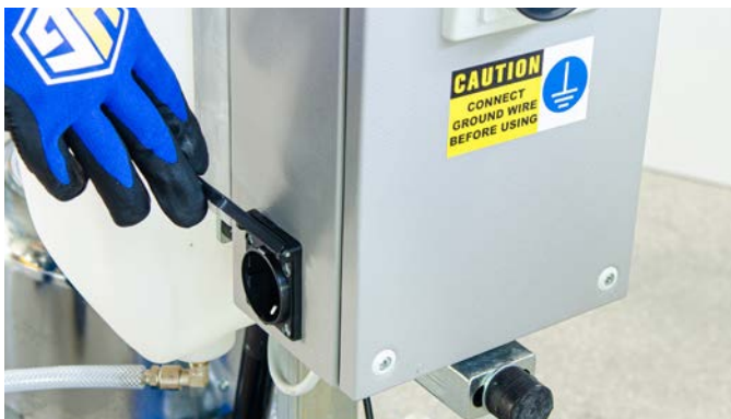
Presa 220V supplementare a bordo posta sul retro dell'asta manico.
