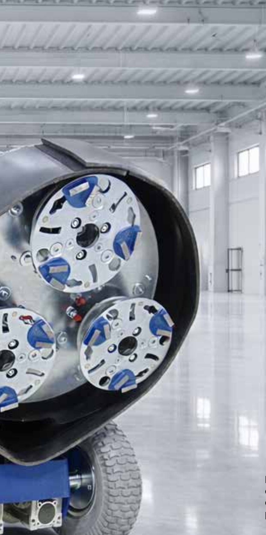
Piatti porta utensili calamitati. Gli utensili vengono guidati in posizione con precisione, riducendo il rischio di cadute accidentali e prevenendo possibili danni al pavimento o agli strumenti stessi.
