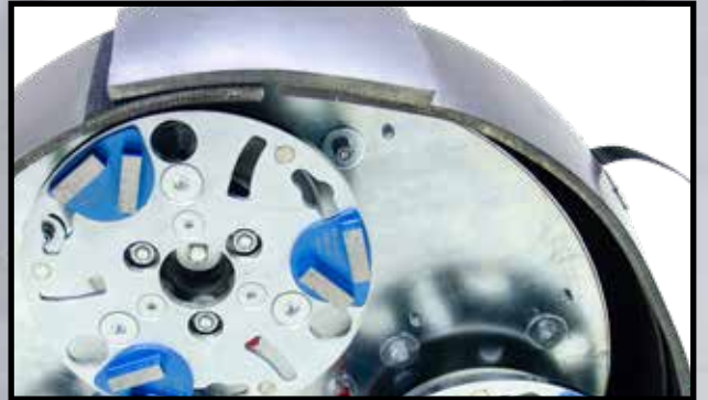
Piatti porta utensili calamitati. Gli utensili vengono guidati in posizione con precisione, riducendo il rischio di cadute accidentali e prevenendo possibili danni al pavimento o agli strumenti stessi.
