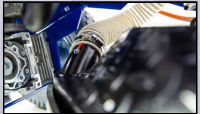
Nuova camera di aspirazione per ottimizzare le prestazioni del sistema e garantire un ambiente di lavoro più pulito.
