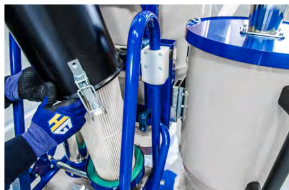
Filtro HEPA di grandi dimensioni.
