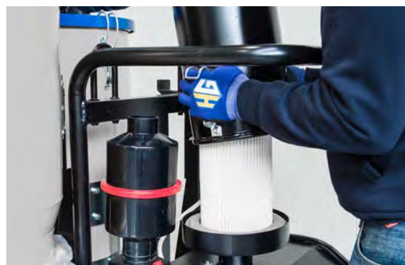
Filtro HEPA di grandi dimensioni.
